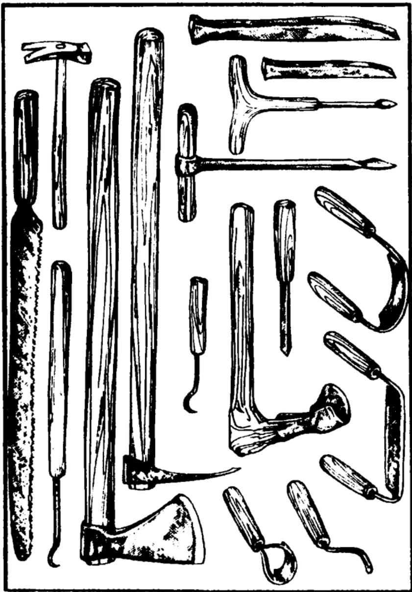
Один из первых буравов был обнаружен при раскопках древнего селения Лебедка в Орловской области. Он напоминал собой железный гвоздь с утолщенной острой граненой "головкой". Хвостовая часть его несколько расширена, образуя ручку. Более поздние бурава XV века уже напоминали современные: деревянная ручка крепилась перпендикулярно металлической части, а рабочий острый конец был слегка винтообразно закручен.
