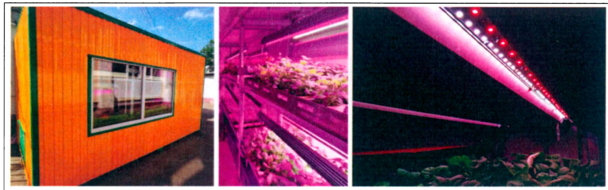
Рис. 4. Общий вид климатической камеры контейнерного типа, вид изнутри и фитоблучатель, установленный на стеллажной системе
