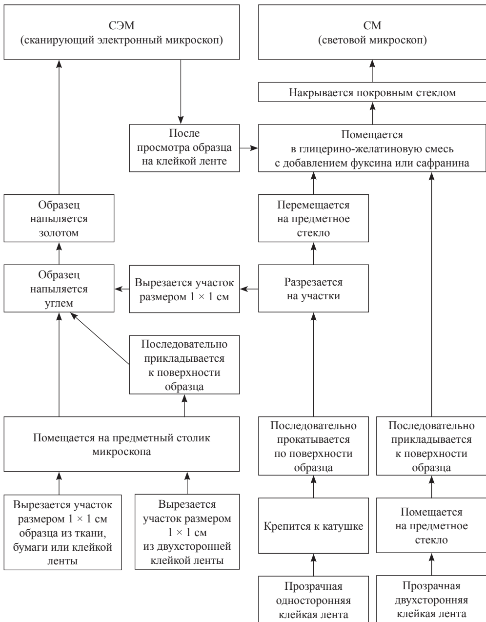
Рис. 6. Схема подготовки образцов к просмотру в СМ и СЭМ
