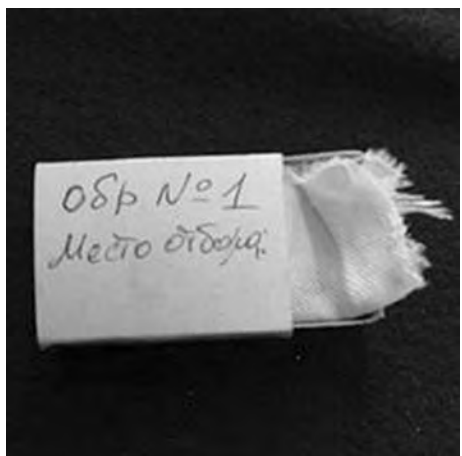
Рис. 7. Спичечный коробок для хранения х/б ткани: a – для отбора пыли; б – с образцом пыли; в – с образцом пыли, завернутым запыленной стороной внутрь; г – извлеченной из коробка, из которой вырезан запыленный участок 1 см 2 для просмотра в СЭМ
