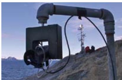
*Дистанционно управляемая видеокамера, установленная на лежбище сивучей (о. Чизвел, Аляска). На заднем плане видны передающая телесистема и ветрогенератор.*
