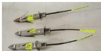
*Спутниковые метки для установки на китообразных.*
