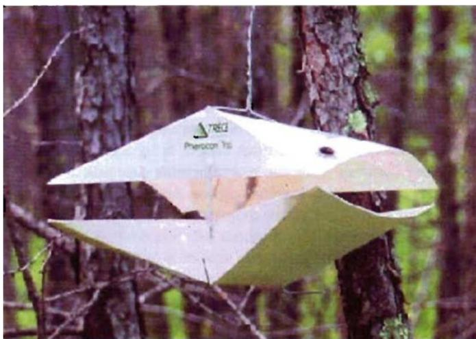
Рис. 30. Крыловая феромонная ловушка
