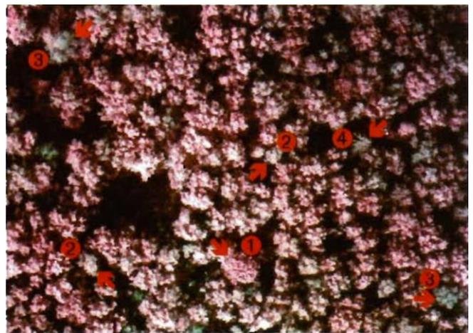
**Рис. 22. Фрагмент сверхкрупномасштабного спектрозонального аэрофотоснимка СН-6М с изображением: здоровых (1), ослабленных (2), сильно ослабленных (3) и усыхающих (4) деревьев березы**
