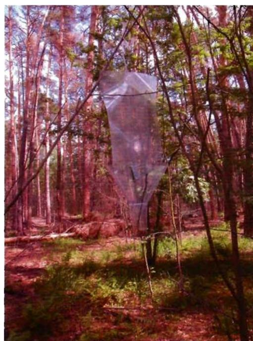
Рис. 33. Барьерная феромонная инсектицидная ловушка на короеда-типографа
